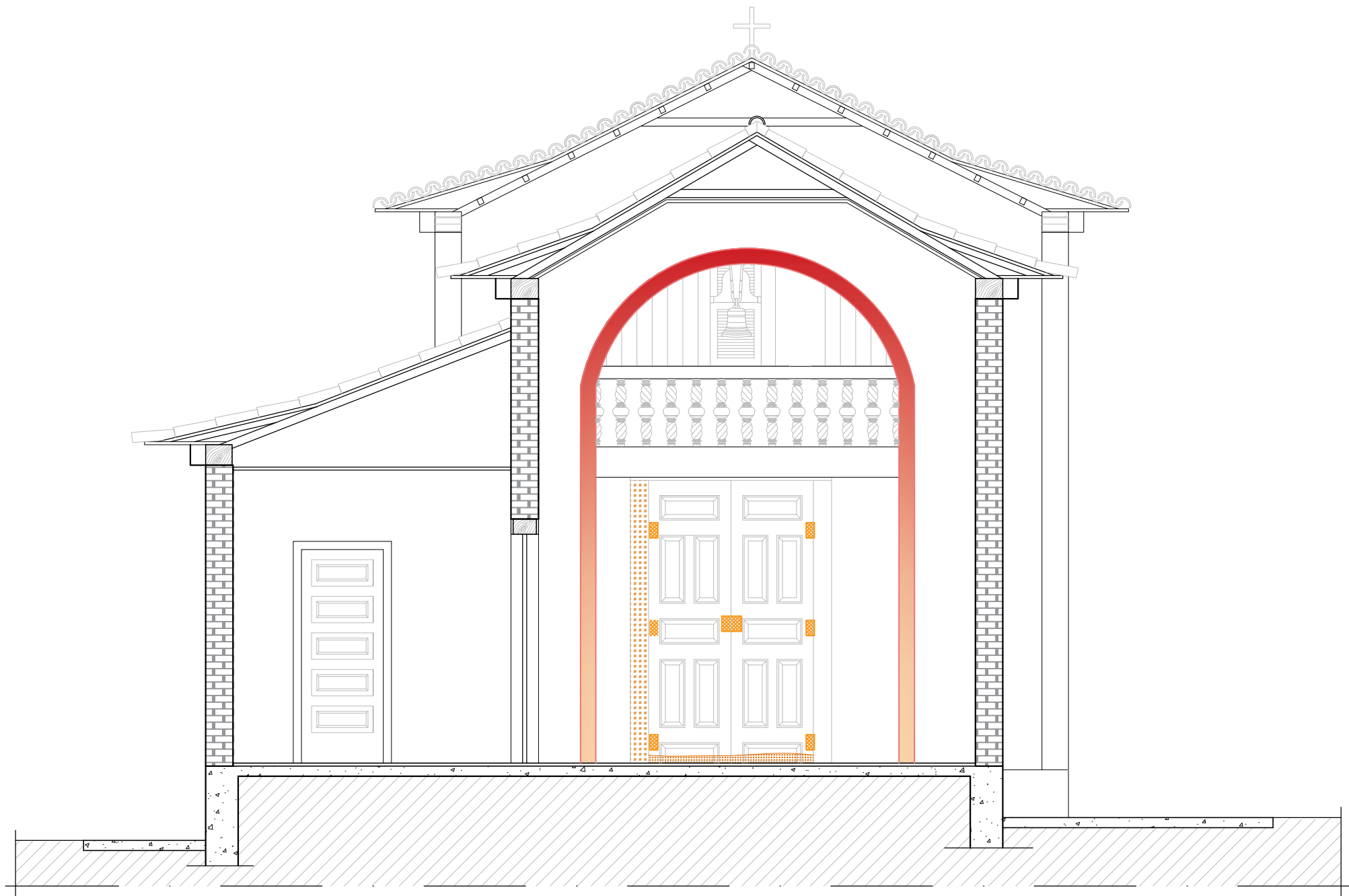
MAPEAMENTO DE DANOS CAPELA N. S. SANT'ANA- CORTE BB ESCALA 1:50
