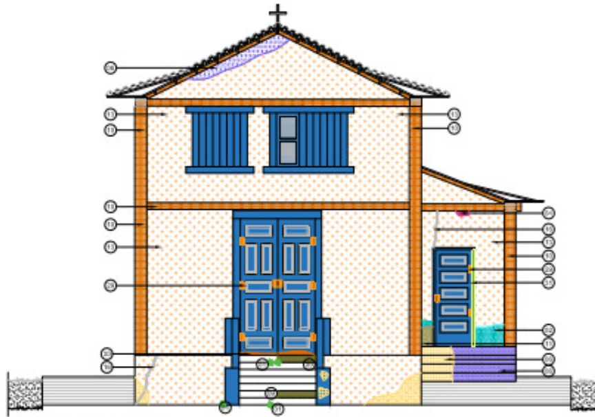
MAPEAMENTO DE DANOS CAPELA N. S. SANTANA- FACHADA FRONTAL ESCALA 1:50
