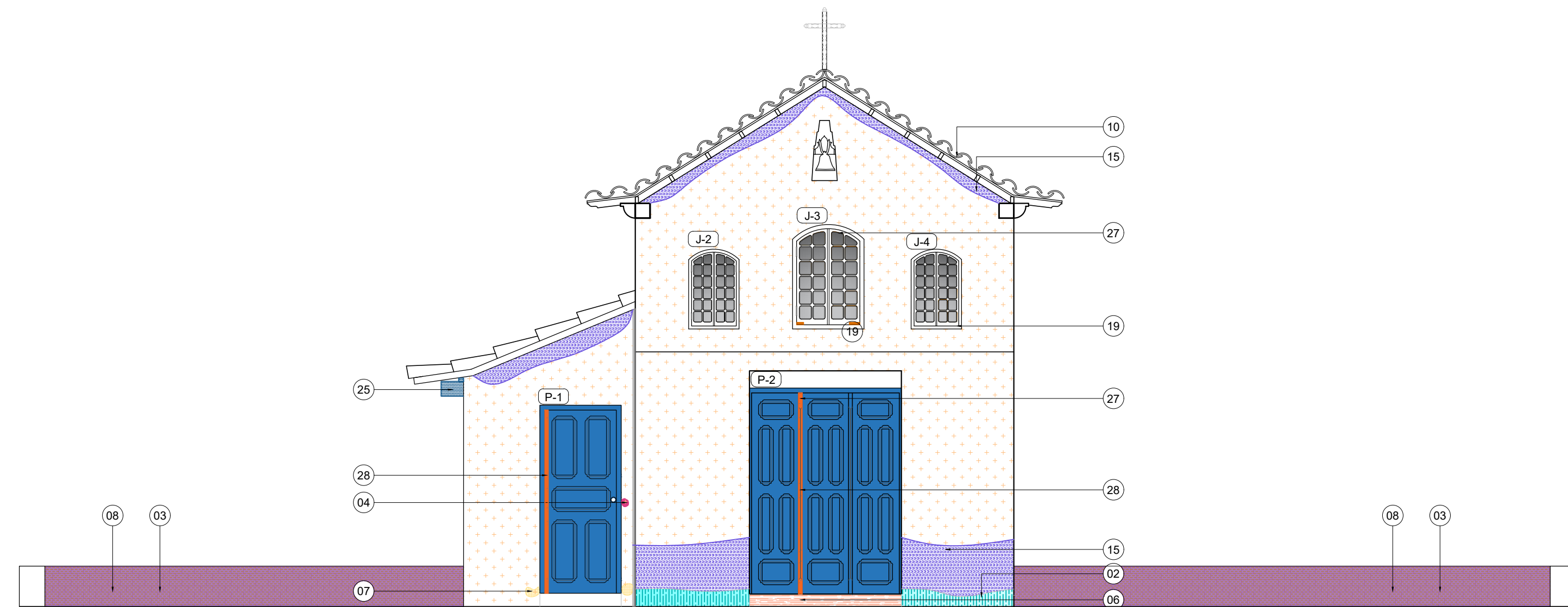
MAPEAMENTO DE DANOS CAPELA N. S. DA CONCEIÇÃO - FACHADA FRONTAL
